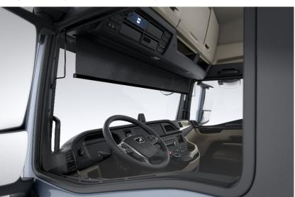
Store pare-soleil des vitres latérales de porte, intérieur, mécanique, côté conducteur et convoyeur
