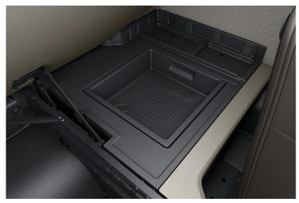
Coffre de rangement, arrière, à droite, accessible de l'extérieur et de l'intérieur, avec berceau de fixation 0P2H5
