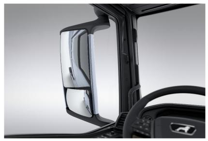
Rétroviseur guide-trottoir, à droite, réglage électrique, chauffant
